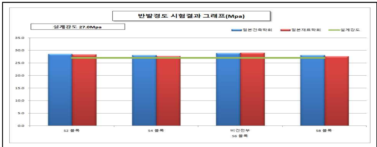
【그림 72.7】 반발경도시험 측정결과
